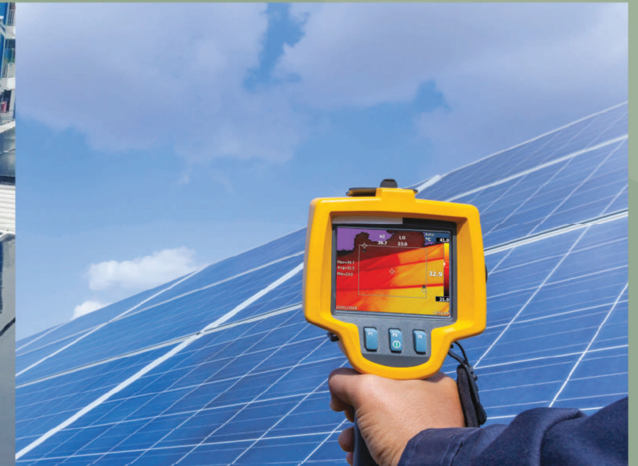
การวัดอุณหภูมิแผงโซลาร์ เพื่อตรวจสอบคุณภาพของแผง
